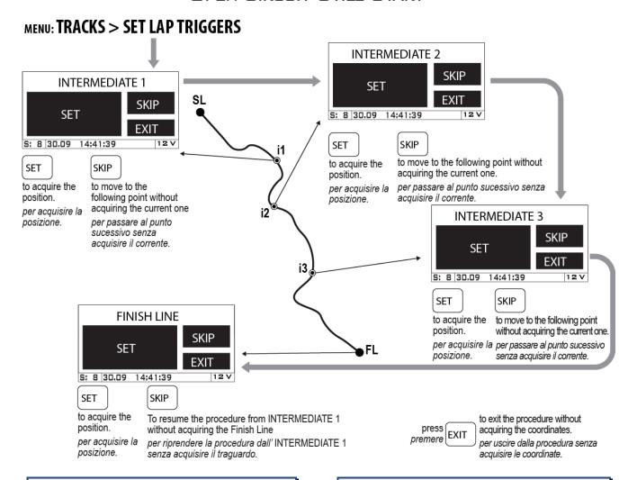
NOTA: you are not required to set up the Start Line in the still start mode since the device starts timing when the internal accelerometer detects the movement upon the vehicle start-up. NOTA: nella modalità con partenza da fermo non è necessario impostare la Start Line in quanto il dispositivo inizia il cronometraggio quando l'accelerometro interno rileva il movimento alla partenza del veicolo.
