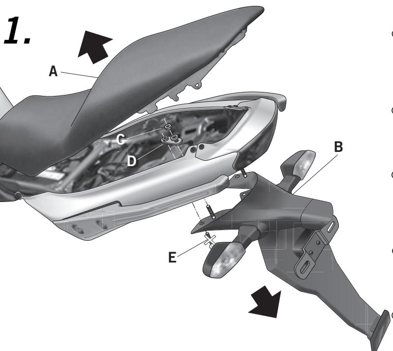
(E) Desmontar el asiento (A). Desmontar el guardabarros trasero (B) mediante las tuercas interiores (C) y los tornillos inferiores (E) que se desestiman. Nota: las chapas interiores (D) no desestimarlas, ya que se utilizarán en el montaje.
