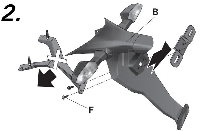
(E) Desmontar y desestimar el soporte refuerzo (F) del guardabarros trasero (B).
