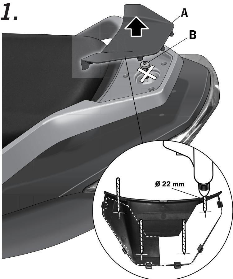
(E) Desmontar la tapeta trasera (A) del agarradero posterior. Realizar los 4 agujeros según la plantilla a Ø22 mm (Nota: Recomendamos no realizar el agujero de Ø22 de una sola vez, sino ir realizando de Ø inferiores hasta llegar al Ø de 22). Desmontar y desestimar el tornillo (B).
