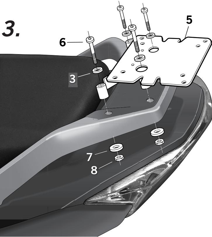
**COMPONENTES / PARTS / COMPOSANTES / EINZELBAUTEILE / COMPONENTI:**
