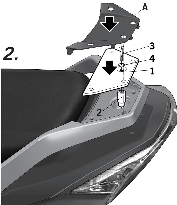
(E) Colocar la chapa refuerzo (1), centrarla y fijarla con el distanciador (2), la arandela (3) y el tornillo (4). Montar la tapeta trasera (A).
