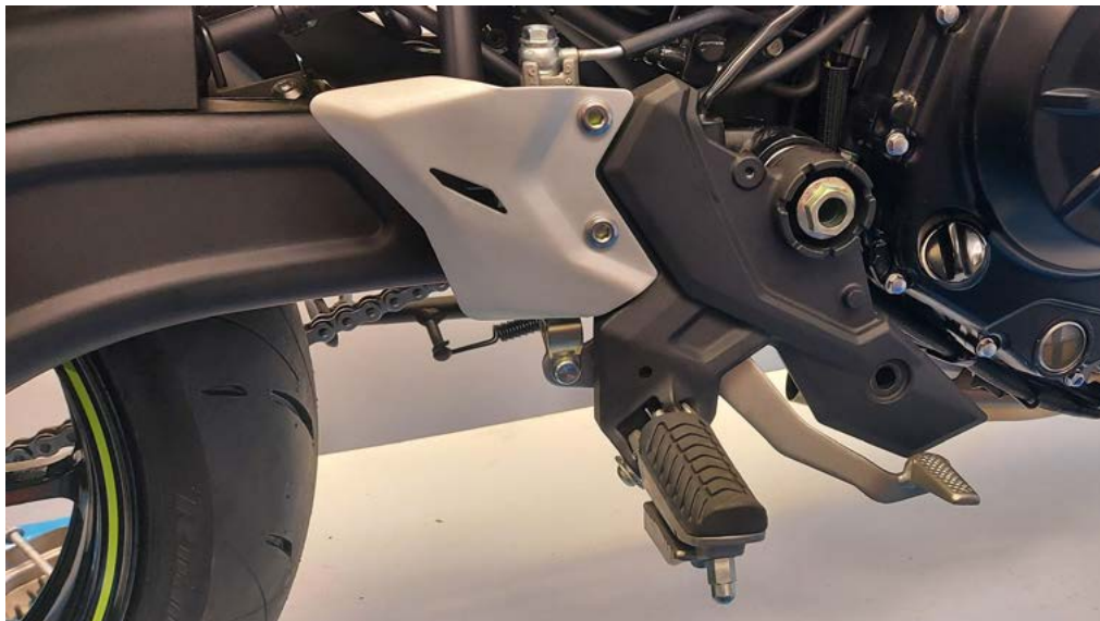
PHOTO 10 (KAWASAKY NINJA 650) LOOSEN THE DRIVER'S R.H. FOOTBOARD
