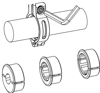
Diametri compatibili: da 12 a 32 mm, se necessario utilizzare i distanziali plastici in dotazione.
