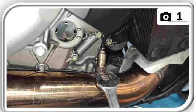
IT Smontaggio sonda gas di scarico anteriore. EN Disassembly of the front exhaust gas probe. DE Ausbau der vorderen Auspuff- Gas-Sonde. FR Démontage de la sonde gaz de l'échappement arrière. ES Desmontaje de la sonda de gas de descarga delantera. PT Desmontagem da sonda dos gases de escape dianteira.
